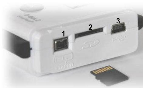
1: Anschluss für Tachograph-Kabel
